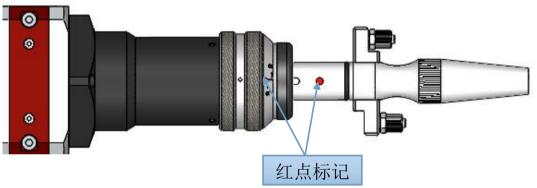
⑥ 将QBH连接器拧至锁紧状态:顺时针方向旋至极限位置(可以感觉到"噔"的一声),向上提起旋转螺母,再次顺时针旋转螺母直至压紧光纤头。(注意转到位即可,不要大力拧动,否则可能会损坏内部结构)
