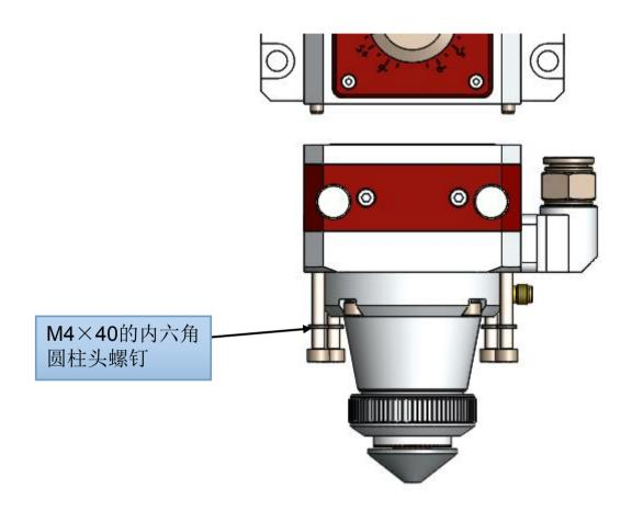
2、装配顺序如右图所示,更换聚焦保护镜(规格PMD30T5)。
