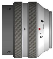
⑤ 光纤头上红点对准QBH连接器的红点,慢慢将光纤头插入QBH连接器中。
