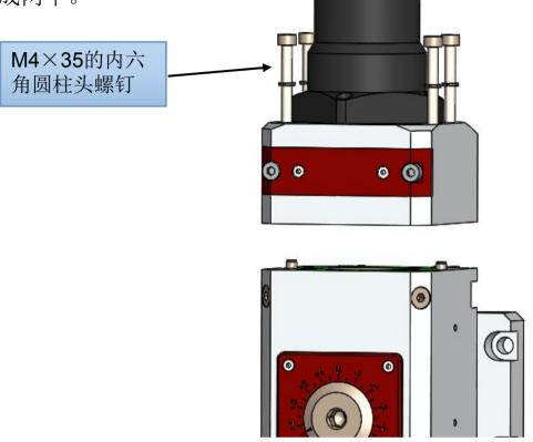
② 使用3mm内六角扳手松掉2颗调中螺丝,取出准直安装模块。
