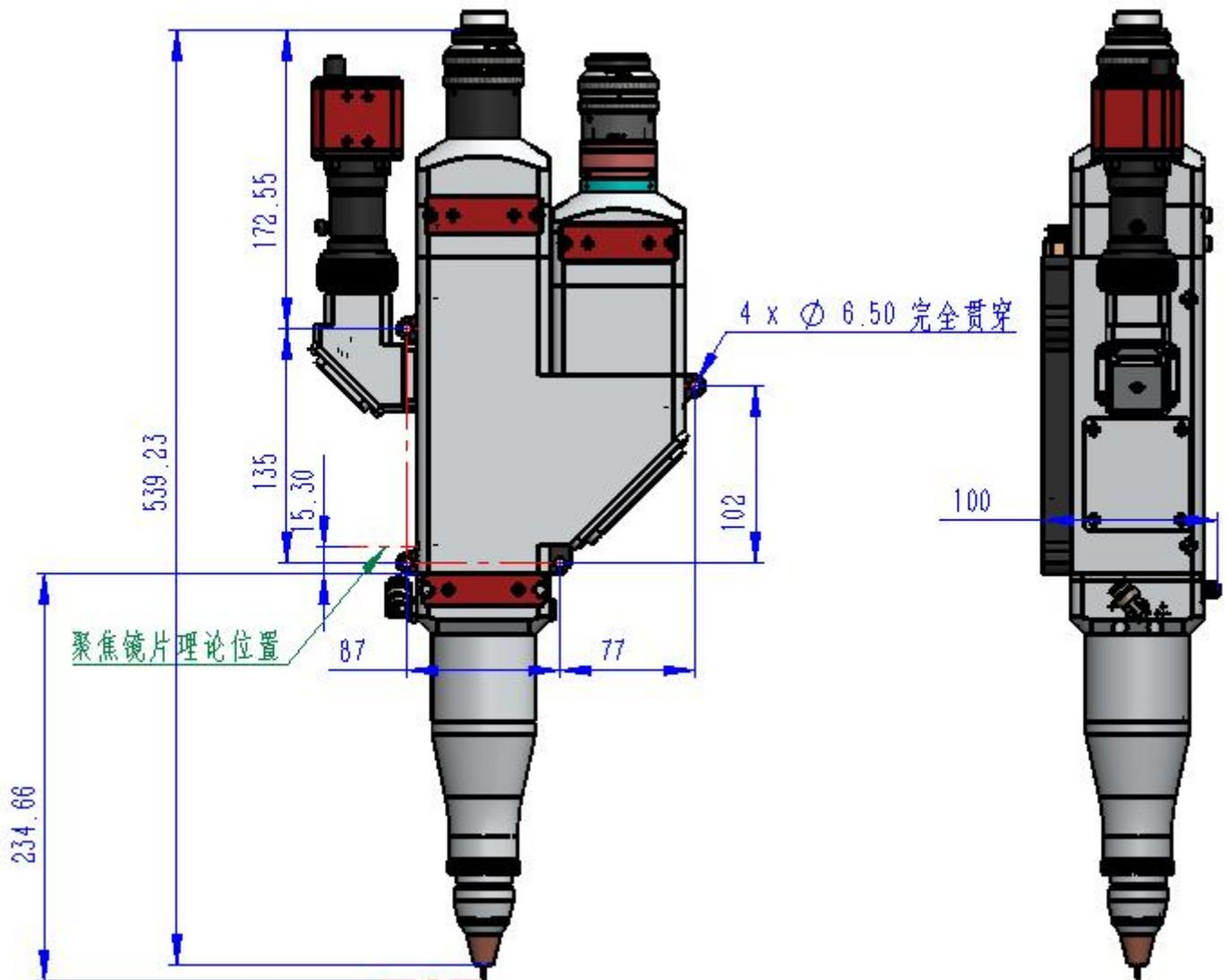
焊接头主要尺寸示意图（准直100/聚焦F200）
