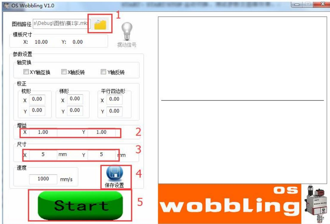
设置X增益：按照上图步骤，（其中1打开“横1字”图档，2设置X为1）。测量实际尺寸为X，计算 $5/X$ 的值，将 $5/X$ 的值填入增益X后点击保存。
